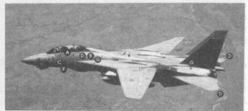
Рис. 3. Размещение элементов приемника AN/ALR-67(V)3/4 на самолетах F/A-18 и F-14: А – панель управления; В – ЭВМ противодействия; С – приемник; D – интегрированный антенный детектор; E – антенный контроллер; F – интегрированная антенна нижнего диапазона; G – квадрантный приемник
