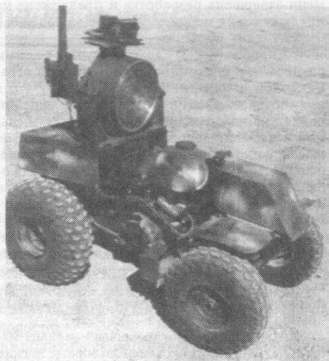
Рис. 4. Роботизированная машина «Файр Ант» с зарядом направленного действия
